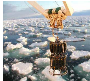
Instrumentation de prélèvement d'échantillons d'eau sur rosette-NISKIN (à gauche) et d'analyses courantométriques sur PROVOR (à droite)
