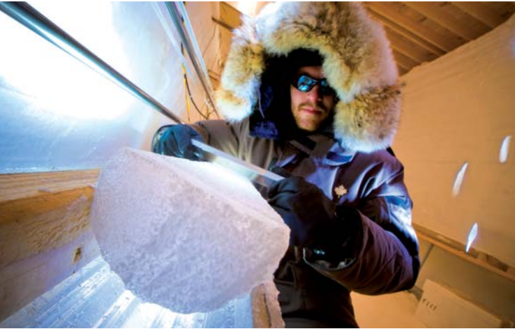
La carotte de glace est découpée en deux demi-cylindres. L'un servant aux mesures de datation, l'autre à l'analyse chimique de la glace.
