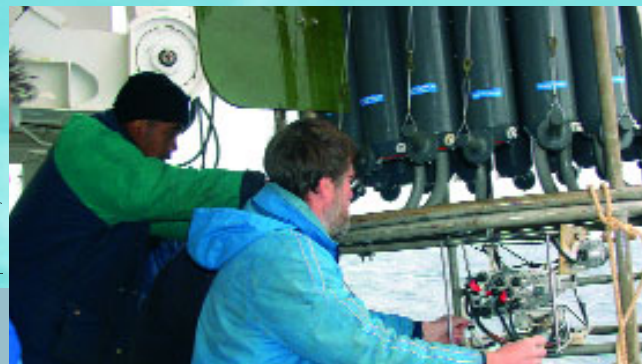
Préparation de la mise à l'eau de la CTD-Rosette à bord du Marion-Dufresne
