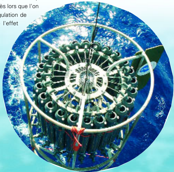
La CTD-rosette est à l'eau. Cet instrument est utilisé durant les campagnes OISO pour récolter des échantillons d'eau de mer à différentes profondeurs, de la surface jusqu'à 5000m. Cela permet l'analyse du CO 2 dans l'océan et d'estimer l'accroissement de CO 2 dans l'océan à toute profondeur (photo G.Guigand/LBCM).
