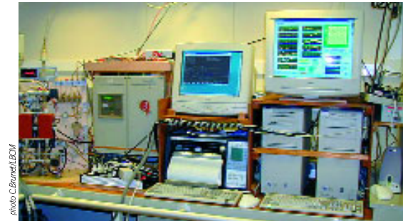
Stand de mesure de CO 2 en continu dans le laboratoire à bord du Marion-Dufresne
