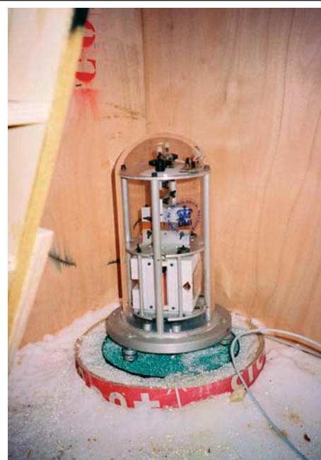
Figure 3. Variomètre triaxial à vanne de flux installé sur un pilier dans la cave de l'abri des variomètres. Le pilier est enfoncé dans le névé sur une hauteur de 1,5m. Le variomètre est de type suspendu, enregistrant trois composantes du champ, respectivement dans les directions N-S magnétique, E-W magnétique et verticale, au rythme d'une mesure par seconde pour chaque composante.
